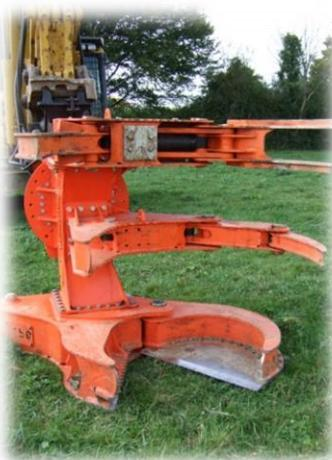
Avec l'utilisation du grappin coupeur sur pelle, le rendement est 5 à 8 fois plus rapide qu'avec une tronçonneuse. Ce matériel limite la pénibilité du chantier lors de l'abattage, il permet d'obtenir une plus grande sécurité du personnel. Son impact sur le terrain, même humide, est limité grâce à la présence de chenilles. Le bois peut être entassé en andain, ce qui permet une manipulation optimale et un gain de temps.
