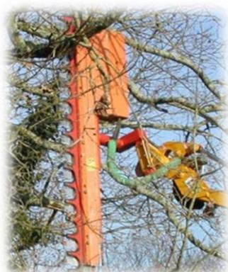
Le sécateur s'adapte sur l'épareuse. Deux scies longitudinales oscillent l'une contre l'autre (mouvement de va et vient). La longueur moyenne est de 2 mètres.
