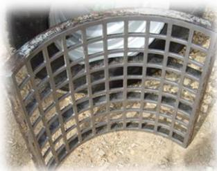
L'utilisation de plaquettes pour de la litière ou pour des chaufferies de petite puissance nécessite des plaquettes de petites dimensions, produites avec des grilles de calibrage de 30 mm.
